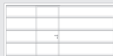
Symmetrische Anordnung bei BRB 2.000 - 3.500 mm – nur mittig
